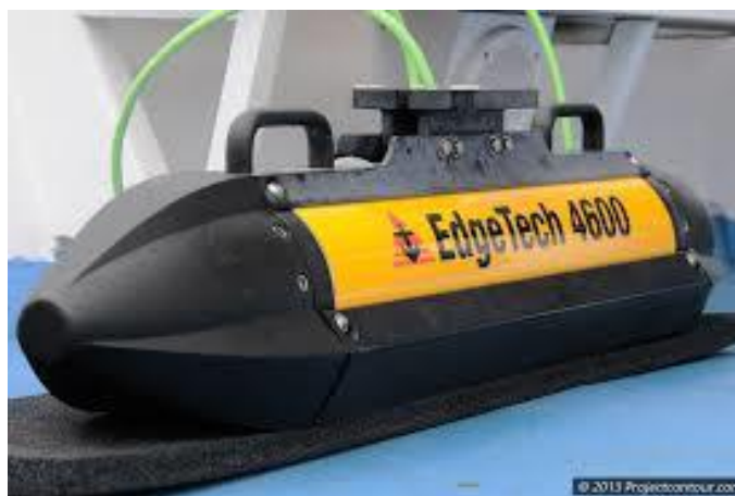
Figura 2 – Ecobatímetro Diferenciador de fase Edgetech 4600
