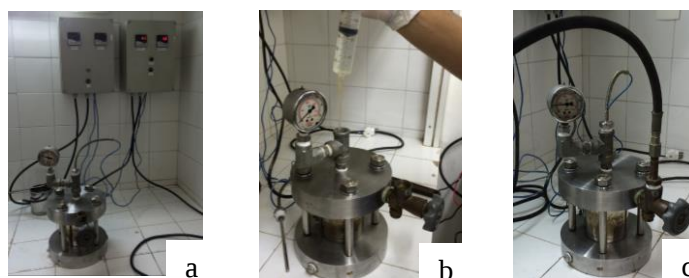
Figura 3. (a) Célula de aço inoxidável para altas pressões com sistema de controle de temperatura e medição de pressão; (b) Injeção de 100 ml de água destilada na célula para realização do ensaio; (c) Pressurização de CO 2 para realização do ensaio.
