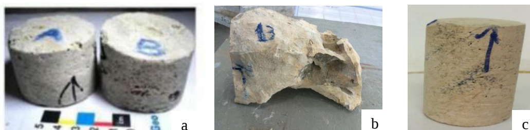
Figura 2. (a) aspecto dos corpos de teste, com aproximadamente 4 cm de diâmetro e 8 cm de altura, do testemunho coletado em Suape; (b) Foto de pedaço do testemunho da formação de Tambaba; (c) aspecto dos corpos de teste, com aproximadamente 4 cm de diâmetro e 8 cm de altura, do testemunho coletado em Tambaba.
