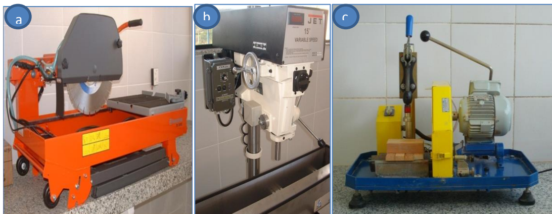
Figura 2: Equipamentos utilizados para preparação dos plugues (a) Serra; (b) Plugadeira de bancada e (c) Retificadora de plugues.
