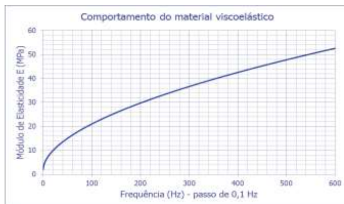
Figura 4 – Comportamento do material viscoelástico com a variação da frequência para uma temperatura fixa (a ambiente do experimento)
