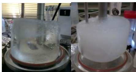
Figura 4 - Imagem da formação de gelo a esquerda e de hidrato de THF a direita.
