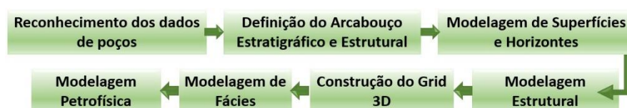
Figura 2: Workflow usado para a geração dos modelos geológicos 3D (Modificado de Passarella, 2012)
