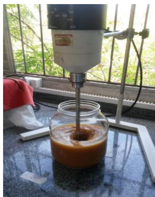
Figura 2: Óleo residual mais metóxido de sódio com metanol em excesso.
