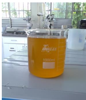
Figura 4: Biodiesel produzido a partir de óleo residual.
