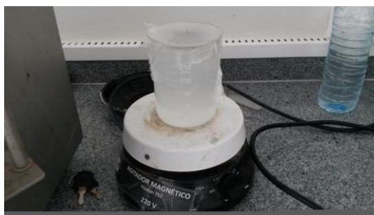
Figura 1: Agitação da mistura NaOH e metanol para a obtenção de metóxido de sódio que funcionará como catalisador da reação.
