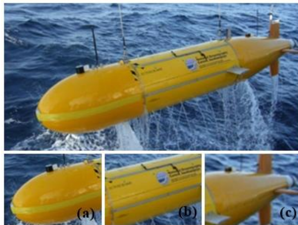
Figura 1 - AUV Autosub6000. (a) Nariz ou popa; (b) Seção cilíndrica do meio do corpo; (c) Cauda ou proa.
