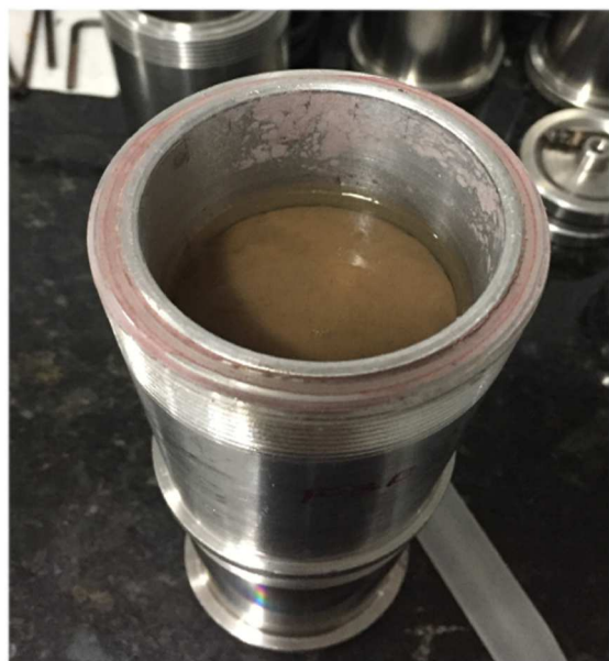
Figura 1: Fluido de perfuração a base de água contaminado com cimento.
