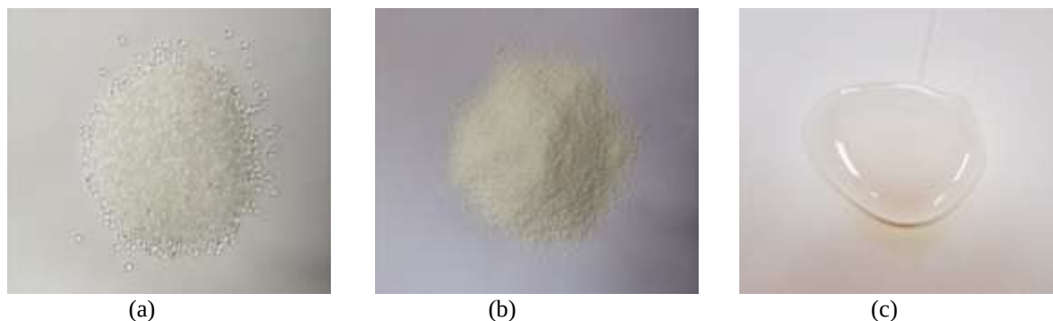
Figura 1 - Ilustração dos modificadores (a) Metacrilato de Glicidila, (b) Terpolímero de Etileno e (c) Ácido Polifosfórico.
