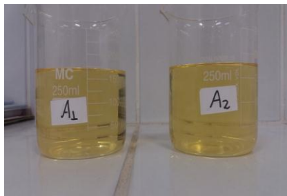
Figura 2 – Amostras de Biodiesel após o processo de purificação e secagem
