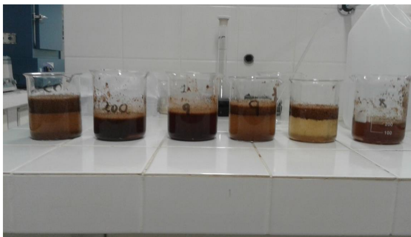
Figura 2 – Mesocarpo com granulometrias variadas em primeiro contato com a água, sendo os três primeiros béckers com material com granulometria de 16 mesh e os três últimos béckers com granulometria superior a 8 mesh, fazendo a contagem da esquerda para direita (Autoria própria).
