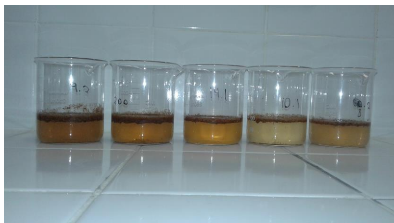
Figura 3 – Mesocarpo com granulometrias variadas em fase de lavagem, sendo os três primeiros béckers com material com granulometria de 16 mesh e os dois últimos béckers com granulometria superior a 8 mesh, fazendo a contagem da esquerda para direita (Autoria própria).
