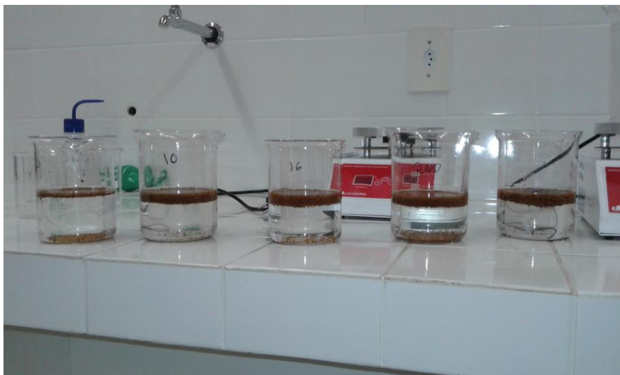
Figura 4 – Mesocarpo com granulometrias variadas na fase final da lavagem sendo os três primeiros béckers com material com granulometria de 16 mesh e os dois últimos béckers com granulometria superior a 8 mesh, fazendo a contagem da esquerda para direita (Autoria própria).
