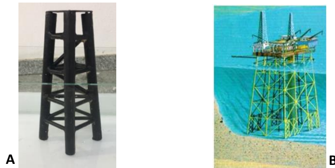
Figura 1: (1A) Detalhes da estrutura construída para o desenvolvimento da análise experimental e (1B) detalhes da plataforma fixa usada como base para a confecção do modelo experimental.
