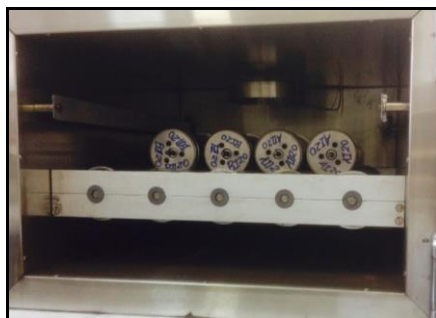
Figura 2 - Células de envelhecimento de fluidos no forno Roller Oven , marca Fann.
