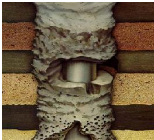
Figura 4 - Exemplo de uma má cimentação
