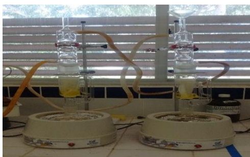
Figura 3 – Sistema de extração do óleo da semente. (Autoria própria)
