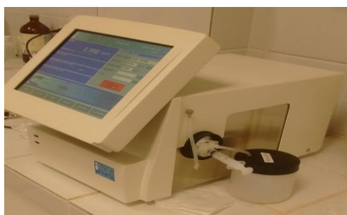
Figura 7 – Densímetro digital de bancada Rudolph Analytical (Autoria própria).
