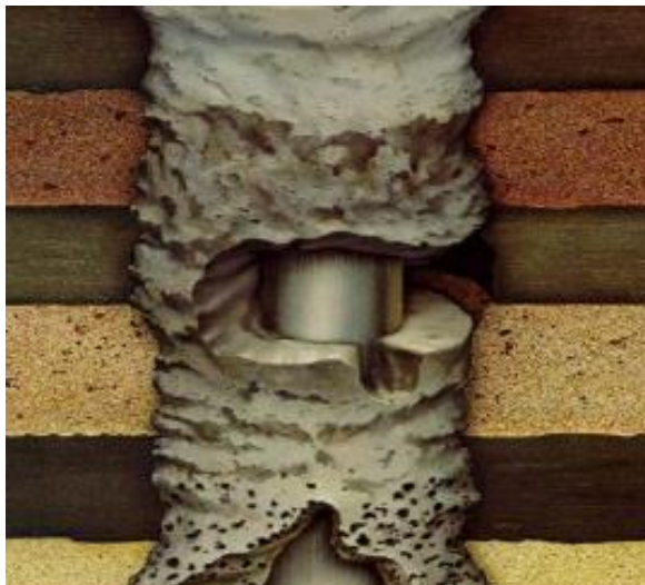
Figura 1- Exemplo de cimentação com malsucedida sem um efetivo isolamento hidráulico. Fonte: Ferreira (2009)
