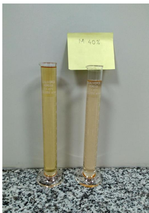
Figura 1 - Determinação da cor para a amostra adulterada com Metanol 40%.
