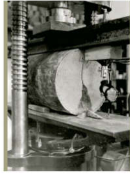
Figura 1: Brazilian Test - Ensaio de compressão diametral de um rolo de concreto, realizado pela Divisão de Materiais de Construção, década de 1940 (CALADO, 2005).
