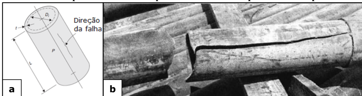
Figura 2 – Na esquerda: esquema da falha do tipo burst em um tubo. Na direita: representação de uma falha do tipo burst ocorrida em um revestimento removido do poço Taylor 177, aplicado numa profundidade de 497 pés e sob diferencial de pressão de 3800 psi.
