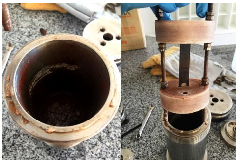
Figura 7. Célula com salmoura evaporada e seus sais precipitados.
