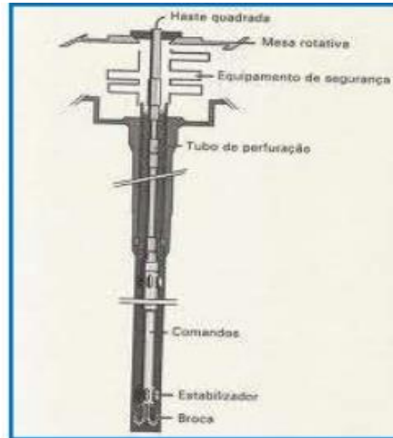
(Figura 1: Esquema de uma coluna de perfuração)
