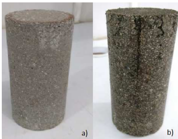
Figura 6: Corpos de prova a) antes e b) após a dissolução.
