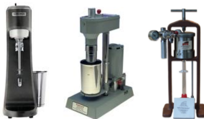
Figura 1. Agitador, equipamento do teste de viscosidade e o equipamento para teste de filtrado, respectivamente.
